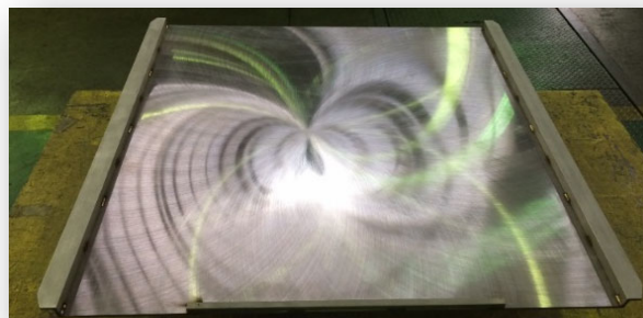
キャリアプレート 鋼種:SUS420J2 Carrier plate Type: SUS420J2
